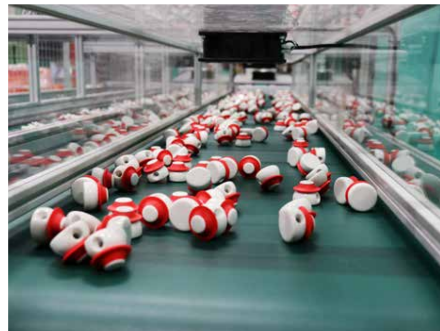
De productie van een tweecomponenten product, de harde beugelsluiting inclusief de zachte ring.
